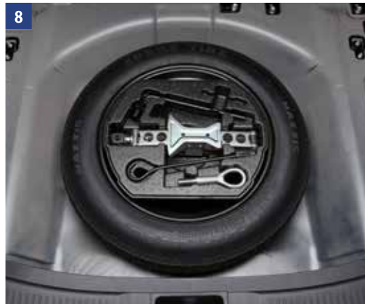
8 | Komplet rezervnega kolesa WVTA 48V Vsebuje pnevmatiko, ventil, kolo, nosilec, oznako, škatlo z orodjem in dvigalko. Kataloška št. 9929P-63T01-000 C D E K L M
